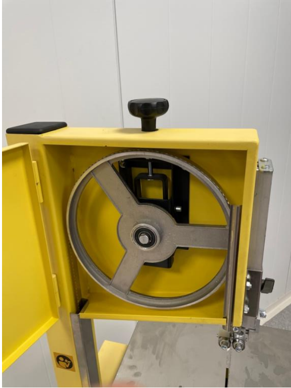
Lett tilkomst for rengjøring med luke inn til øvre og nedre drivhjul
